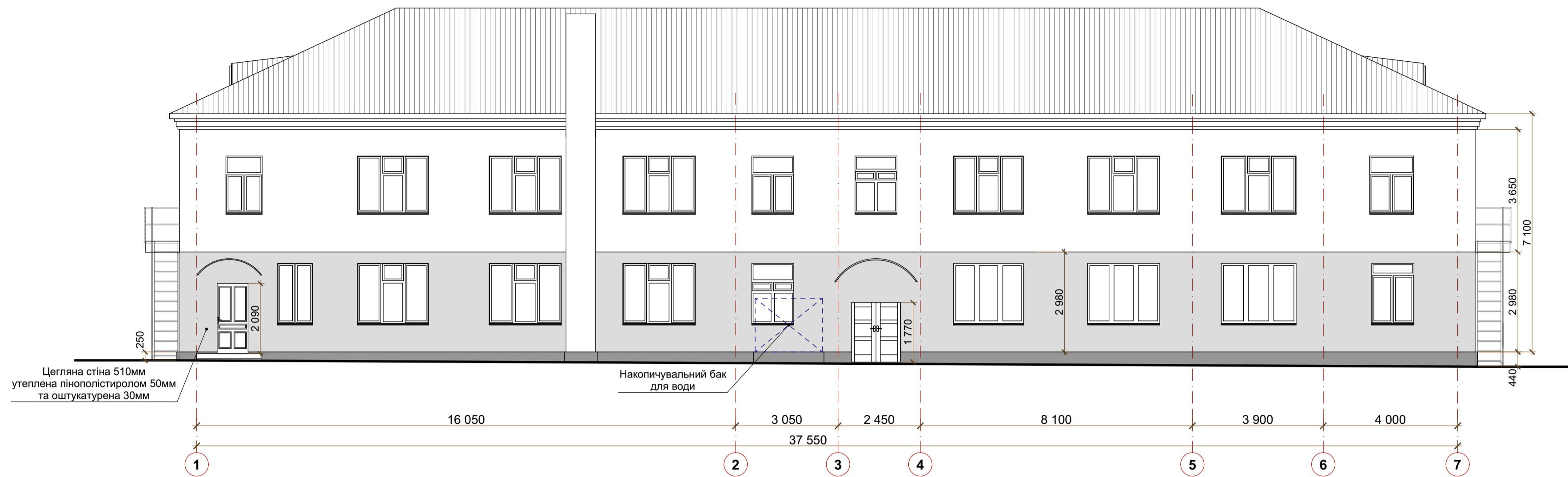
Обміри фасаду в осях 1-7
