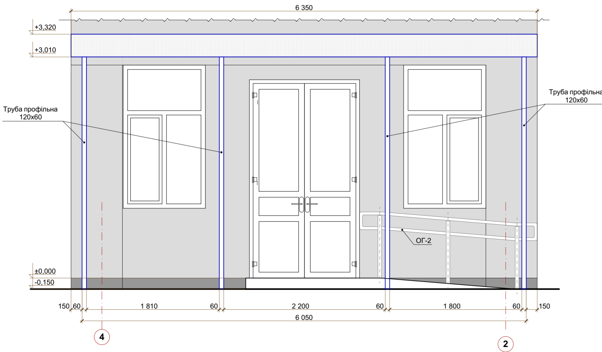
Фрагмент фасаду в осях 4-2
