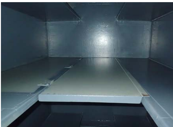
А Большая камера в тюремном вагоне с разложенной маленькой полкой между двумя средними полками. © Эрмест Мезак
