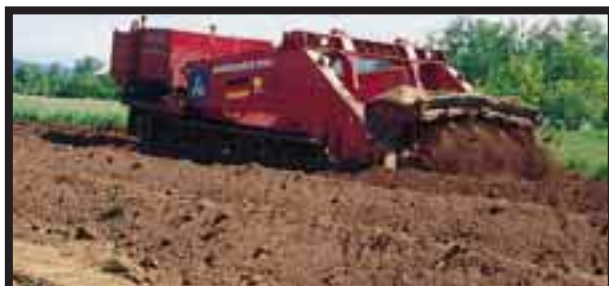
地雷原とみられる土地を掘りかえすドイツ製の地雷破壊機(サラエボ空港)。
