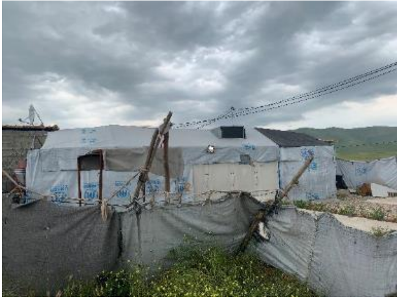
Mixed installed extensions and not respecting fire breaks ملحقات مثبتة مختلطة ولا تحترم فواصل الحريق
