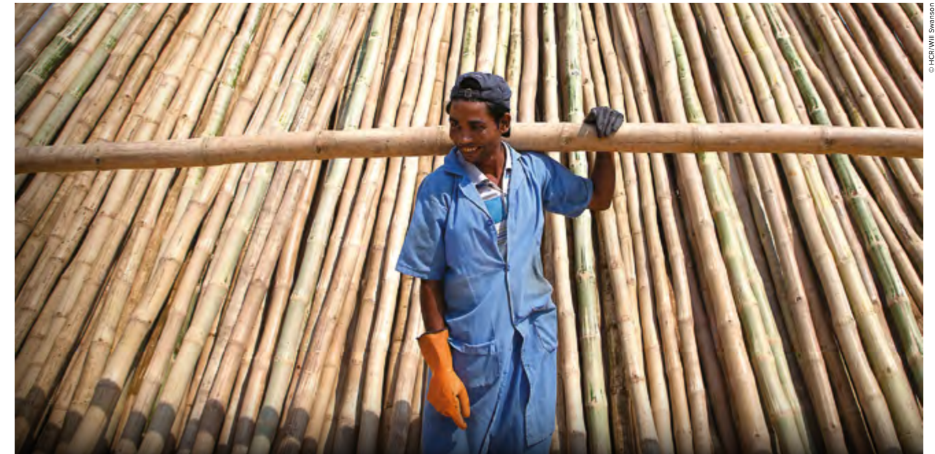
Nor Kalam, 25 ans, aide à préparer des grumes de bambou pour un traitement chimique dans le camp de Kutupalong, au Bangladesh. Le traitement des bambous permet de créer des logements plus durables dans les camps.
