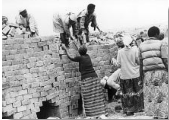
女性の自立プログラムのひとつであるレンガ作り。女性たちの手で粘土に水が混ぜられ、焼上げられていく。
